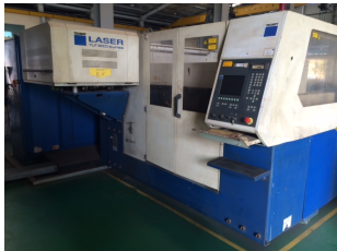
TRUMPF TruLaser 3030 3kW, t=0.3~10mm
